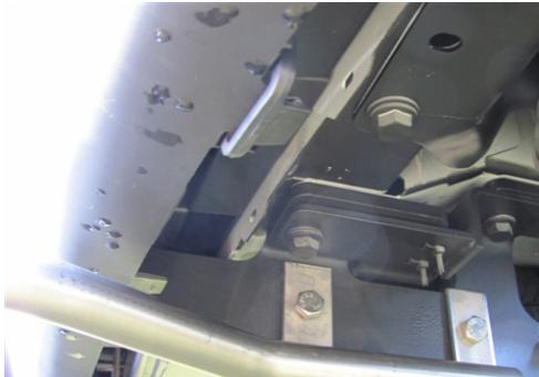
Die Montage der Trittstufe erfolgt durch seitliches Anschrauben an die Unterkonstruktion der Anhängekupplung. Original Schrauben wiederverwenden.
