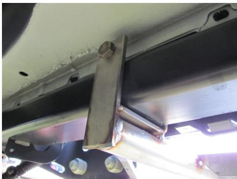
Die inneren Bügel werden mit den mitgelieferten Schrauben am Querträger der Traverse der Anhängekupplung befestigt.
