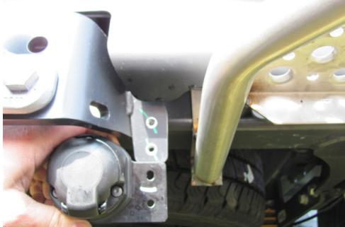
Das mitgelieferte Montageblech dient zur Verlängerung der Halterung des AHK-Steckers.
